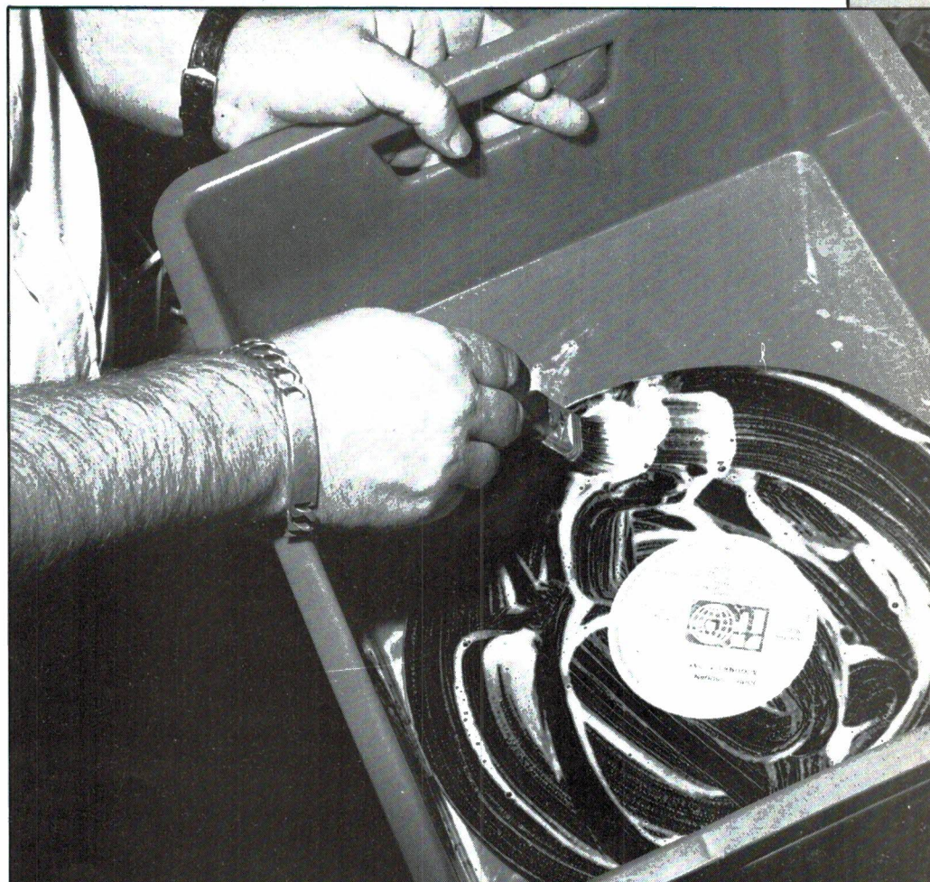
Foto 5. Het schuimende afwasmiddel wordt in de groeven geborsteld.
